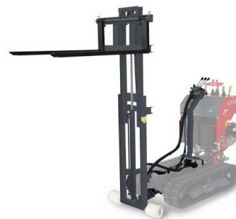
Aliën HY 6.5 met vorklift Aliën HY 6.5 avec élévateur pour rûches
