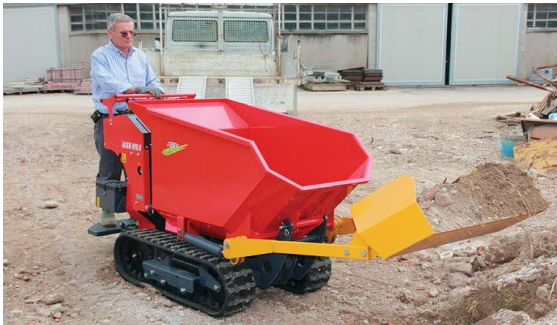
Foto: Aliën HY 8.0 met dumper en frontlader Photo: Aliën HY 8.0 avec cuve et autochargeur
