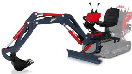
Foto: Aliën HY 6.5 met graafarm 130cm, nivelleerblad en zijje Photo: Aliën HY 6.5 avec excavateur 130cm, pelle et siège
