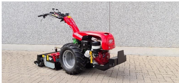
Fort 180 avec pneus ballon, fraise niveleuse MTL75 et support de masse frontal anti-vib avec poids
