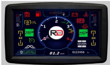
IP65 écran tactile multifonctions certifié avec caméra de recul
