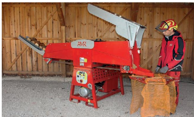
Splitomat avec rotative d'ensachage 3 sacs de 40 L
