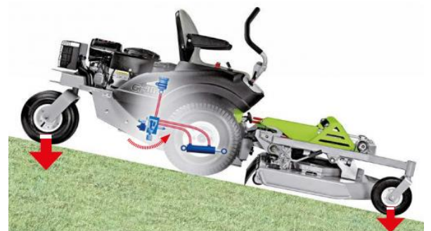
Stabilisation automatique pour maintenir une conduite stable, même pendant des manoeuvres rapides
