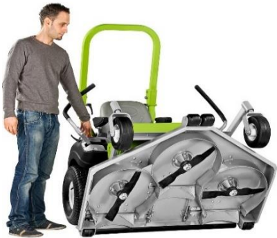
Commande électrique pour mettre la tondeuse en position verticale pour l'entretien
