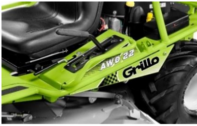
Réglage hauteur de coupe en continu
